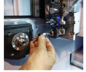
**El sistema tradicional de cambio de herramientas en portaherramientas motorizados no es seguro.**
