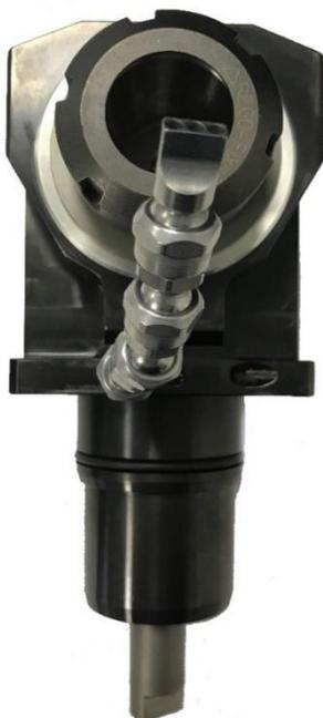
Sistema HECTO montado en un portaherramientas rotativo. Boquilla recta ID:3 mm x 3 & L:20 mm
