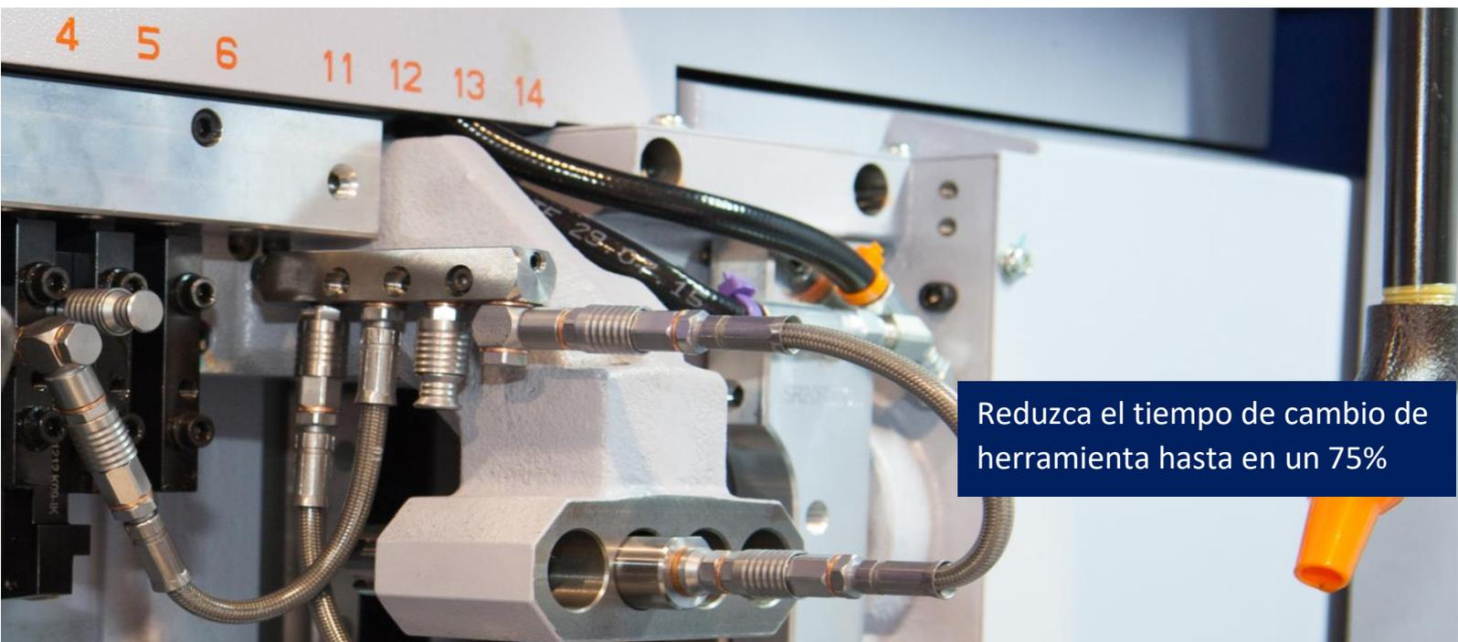
Sistema de distribución de refrigerante (taladrina y aceite de corte) totalmente flexible y modular, capaz de soportar presiones de 220 Bar e ideal para el uso con equipos de alta presión
